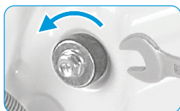
Uvoľnite 4 prepravné skrutky pomocou kľúča.
